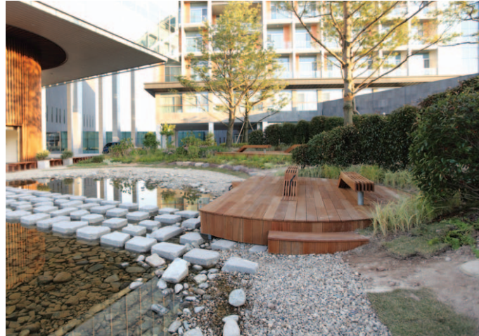
▲ 반원형 데크 주변으로 홍가시를 심어 차폐 효과를 낸다. 이국적이고 비밀스런 공간으로 구성하였다. 데크의 계단면은 원형과 동선을 고려해서 언밸런스하게 설치하고 조명을 위한 등과 전선은 토목과 구조물 제작시 함께 설비하도록 한다.
