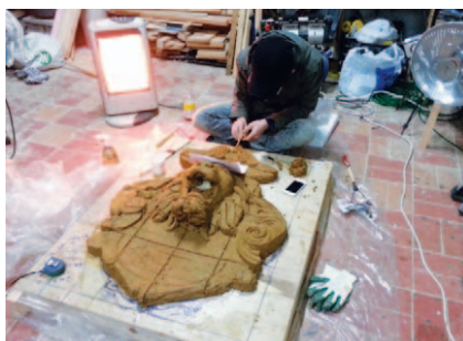
사자상 토수 조형물 구하기가 어려워 직접 제작에 들어갔다. 점토로 원형을 만들고 석고 작업과 여러 단계를 거쳐 청동주를 사자상을 만들었다.
